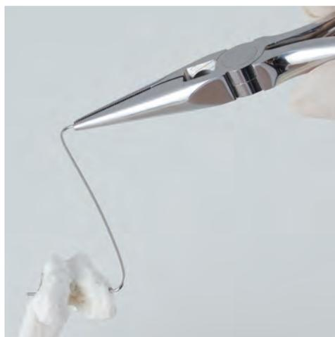
細径のキルシュナー鋼線を把持し押し込む事で曲げ操作が行えます。
