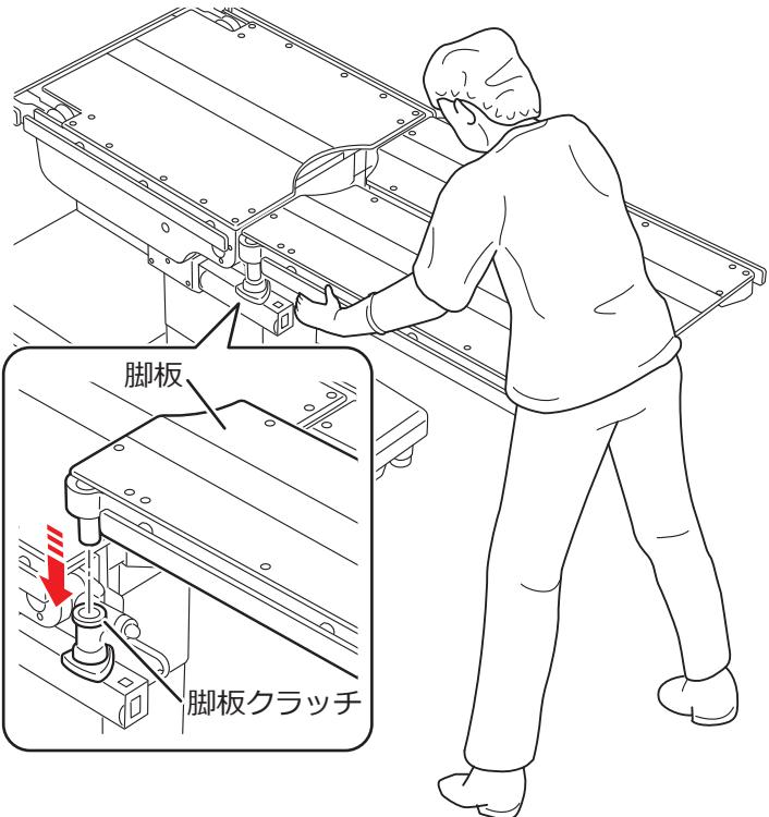
2. 脚板の脚側先端を持ち、脚板クラッチが噛み合うまで脚板固定ハンドルを回して固定します。
