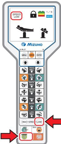
低速モードに切り替わり、**LOW** のバックライトが点灯し、モニター画面に **SPEED LOW** が表示されます。
