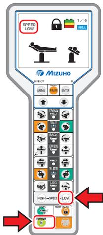
Cambie al modo lento. **LOW** se ilumina y, a continuación, **SPEED LOW** aparece en la pantalla del monitor.
