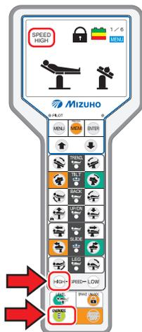
Cambie al modo rápido. **HIGH** se ilumina y, a continuación, **SPEED HIGH** aparece en la pantalla del monitor.
