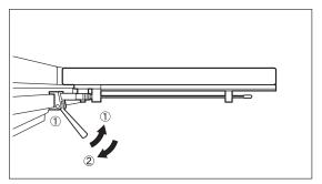
①Cuando tire de la palanca de sujeción hacia usted, instale el apoyabrazos en un raíl lateral de la mesa quirúrgica.
