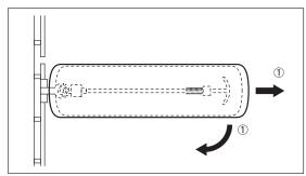
①Después de tirar de la palanca de rotación, el apoyabrazos puede ser rotado hasta 90 grados.
