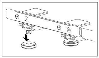
Nota: Si un accesorio interfiere con los tiradores de fijación, los tiradores de fijación se pueden quitar tirando de ellas hacia abajo.
