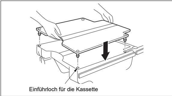
Richten Sie die Beinenden der radiografischen Tischplatte an den Einführlöchern für die Kasette an der Tischplatte aus und führen Sie die Kassettenplatte gerade ein.
