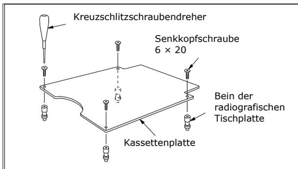
Befestigen Sie die Beine der radiografischen Tischplatte mit Senkkopfschrauben an der Kassettenplatte.
