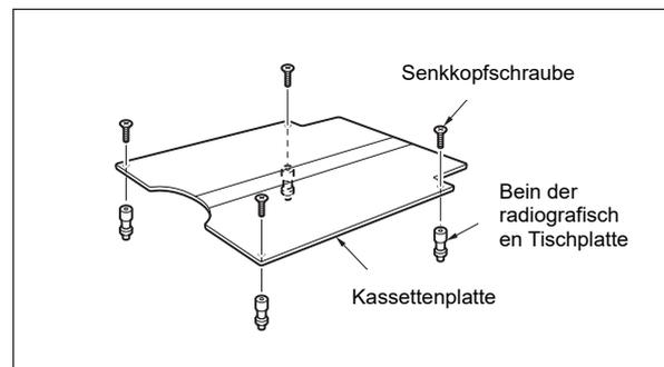
Befestigen Sie die Beine der radiografischen Tischplatte mit Senkkopfschrauben an der Kassettenplatte.
