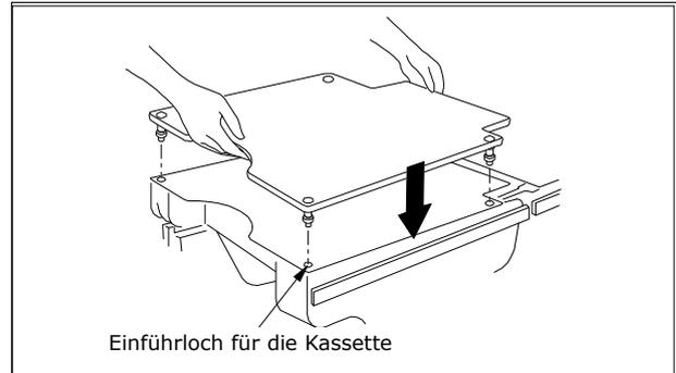
Richten Sie die Beinenden der radiografischen Tischplatte an den Einführlöchern für die Kassette an der Tischplatte aus und führen Sie die Kassettenplatte gerade ein.
