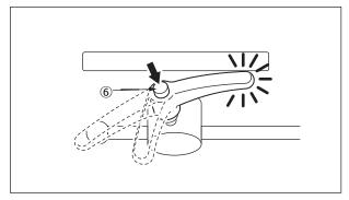
Si le levier de réglage entre en contact avec le plateau et empêche son fonctionnement, déplacez le levier de réglage tout en appuyant sur le bouton.
