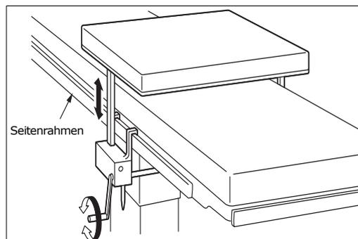
1. Bringen Sie die Fußstütze am Seitenrahmen des OP-Tisches an.
