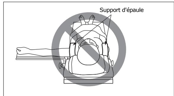
Quand le support d'épaule est en place, ne pas attacher le bras à l'accoudoir en position d'abduction. Le cas échéant, le nerf de la partie supérieure du bras risque d'être paralysé.
