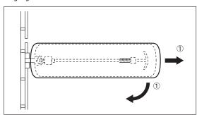
[1] Nach Ziehen des Rotationshebels kann die Armlagerung um bis zu 90 Grad gedreht werden.
