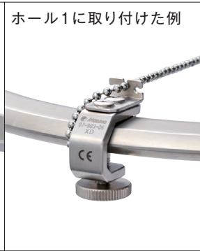
スプリングフックアジャスターには、3箇所の取り付けホールを設けています。各ホールには面取り加工を施し、ボールチェーンが外れにくい構造を採用しています。ただし、写真Aのような巻き付け固定は行わないでください。ボールチェーンに曲げ荷重が加わり、折損するおそれがあります。
