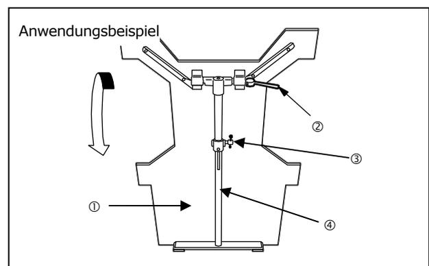
Nutzen Sie den Klapphebel ②, um die Stützstange ④ in die Lagerungsposition zu versetzen.
